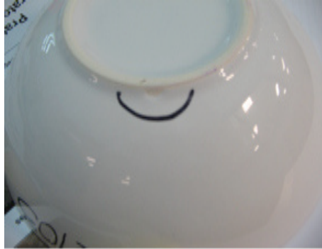
Figura 10 - Falta de vidro na zona do frete
