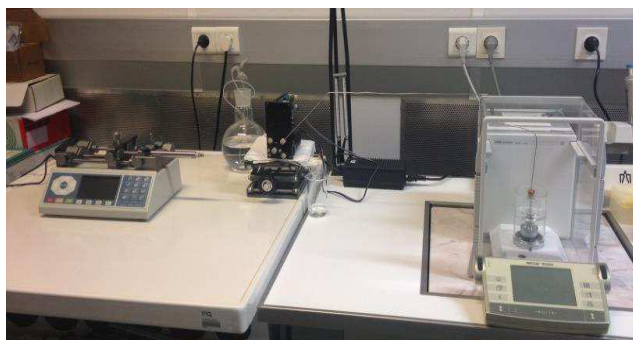
FIGURA 5 - Montagem do padrão para medição de micro caudais para operar entre 10 mL/min e 100 nL/min
