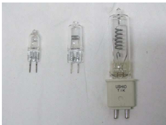
Figura 3. Lâmpadas padrão secundário, com potência de alimentação, da esquerda para a direita: 50 W, 25 W e 1000 W.
