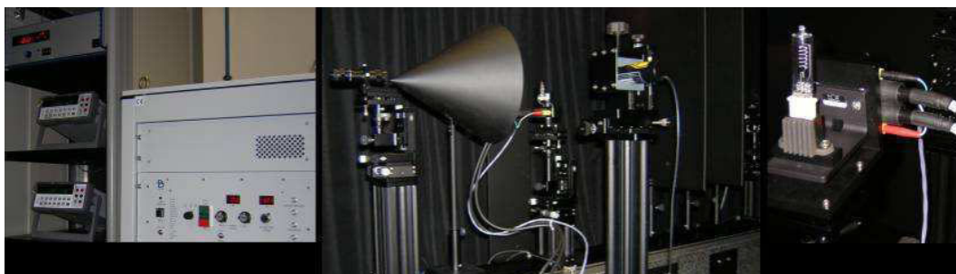
Figura 1 – a) fonte de alimentação; b) banco fotométrico com lâmpadas padrão secundário
