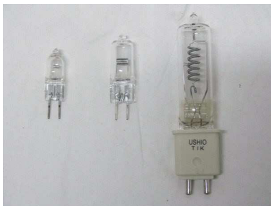
Figura 3. Lâmpadas padrão secundário, com potência de alimentação, da esquerda para a direita: 50 W, 25 W e 1000 W.
