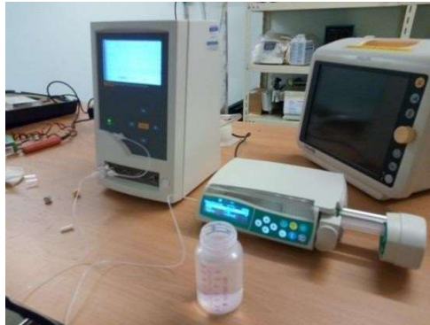
Figura 2 – Montagem da calibração de uma seringa perfusora pelo método comparativo
