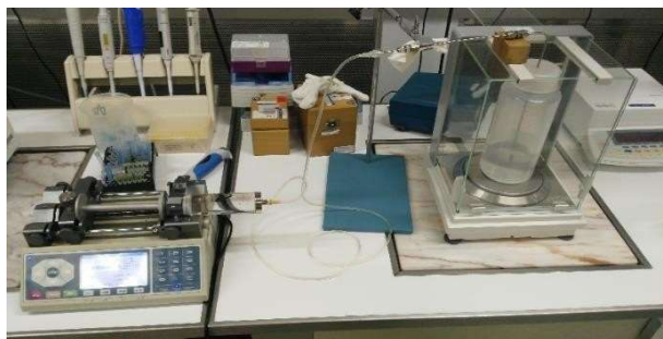
Figura 1 – Montagem da calibração de uma Bomba Nexus 3000 pelo método gravimétrico
