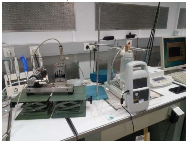
Figura 4- Montagem da calibração gravimétrica do IDA-1S utilizando como gerador de caudal, um contador de Coriolis
